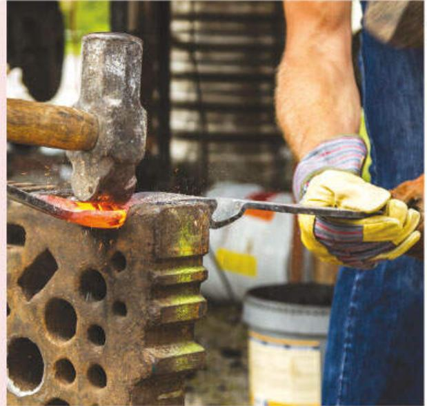
El cambio de color de un objeto metálico se observa con facilidad en un taller de herrería o cuando un soldador trabaja el metal.
