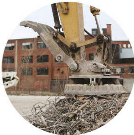
Los electroimanes, como el que construyeron, se usan en diversos aparatos: timbres, frenos de elevadores y montacargas, entre otros. Los más potentes son muy útiles en la industria porque es posible controlar el campo magnético que generan, basta con regular la corriente eléctrica que circula por ellos, es decir, no son imanes permanentes. Por ejemplo, uno de los usos más comunes consiste en levantar y soltar chatarra en los deshuesaderos de automóviles (figura 2.28).
