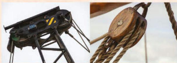
**Figura 1.87** Las poleas facilitan cargar o transportar objetos pesados.
