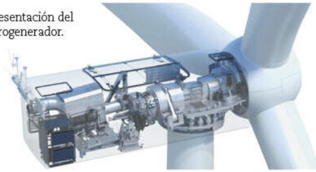
Las aspas de los aerogeneradores giran por la fuerza que ejerce el viento sobre ellas. Este giro, por medio de mecanismos, consigue que un rotor se mueva dentro de un generador y produzca energía eléctrica (figura 2.57).
