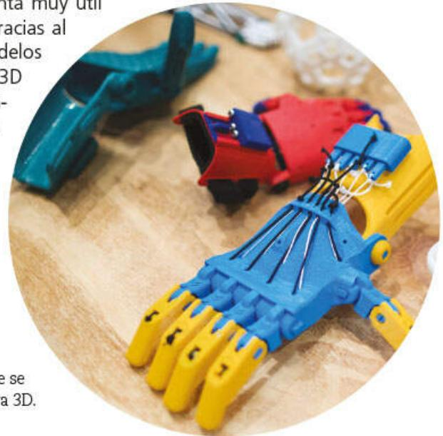
**Figura 1.60** Ejemplos de modelos que se obtienen por medio de una impresora 3D.
