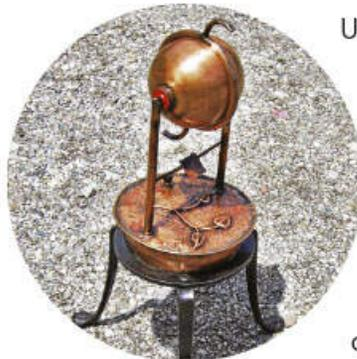
Una *máquina térmica* es un dispositivo que aprovecha la energía calorífica proveniente de la quema de un combustible (carbón, leña, gasolina) y la transforma en otras formas de energía, principalmente cinética. En la actividad 6, la energía térmica aplicada al agua produce vapor; éste a su vez, pone al carrito de juguete en movimiento.
